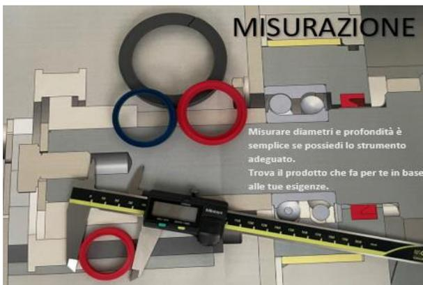
Il calibro serve per misurare il diametro della cava. Utilizzare i bracci lunghi o corti a seconda della profondità del foro.
